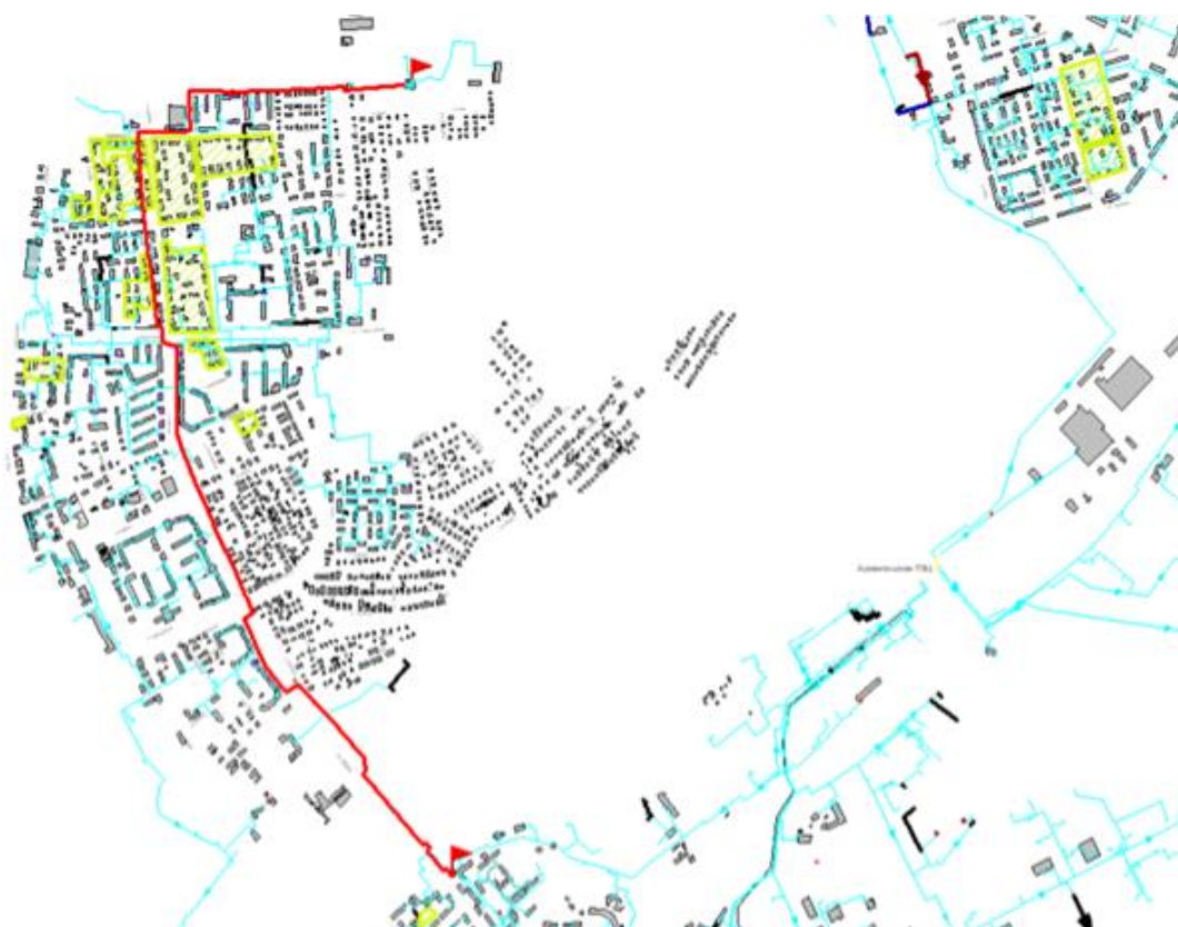
Рисунок 1.2 Путь для расчёта вероятности безотказной работы тепловых сетей от ТК-45 до С-28п-16
