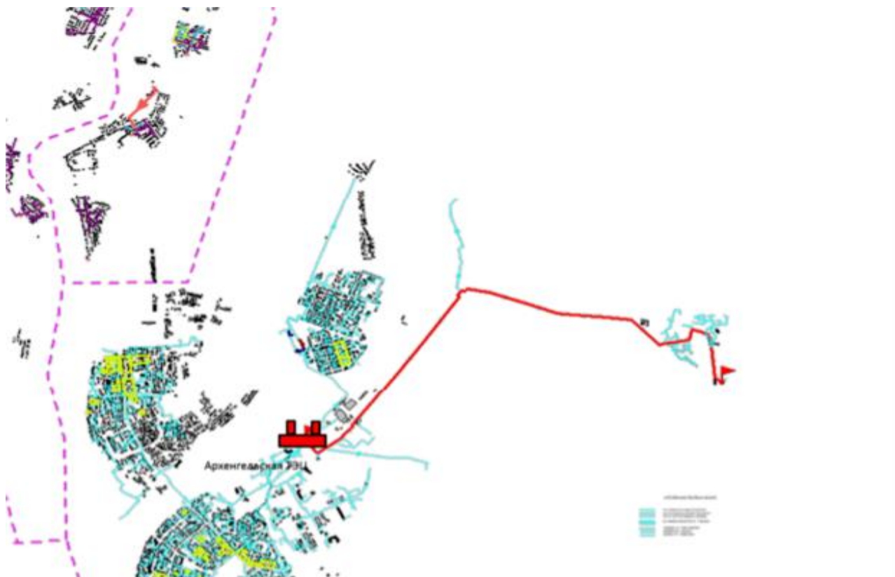
Рисунок 1.7 Путь для расчёта вероятности безотказной работы тепловых сетей от Архангельской ТЭЦ до ТК-18т-4
