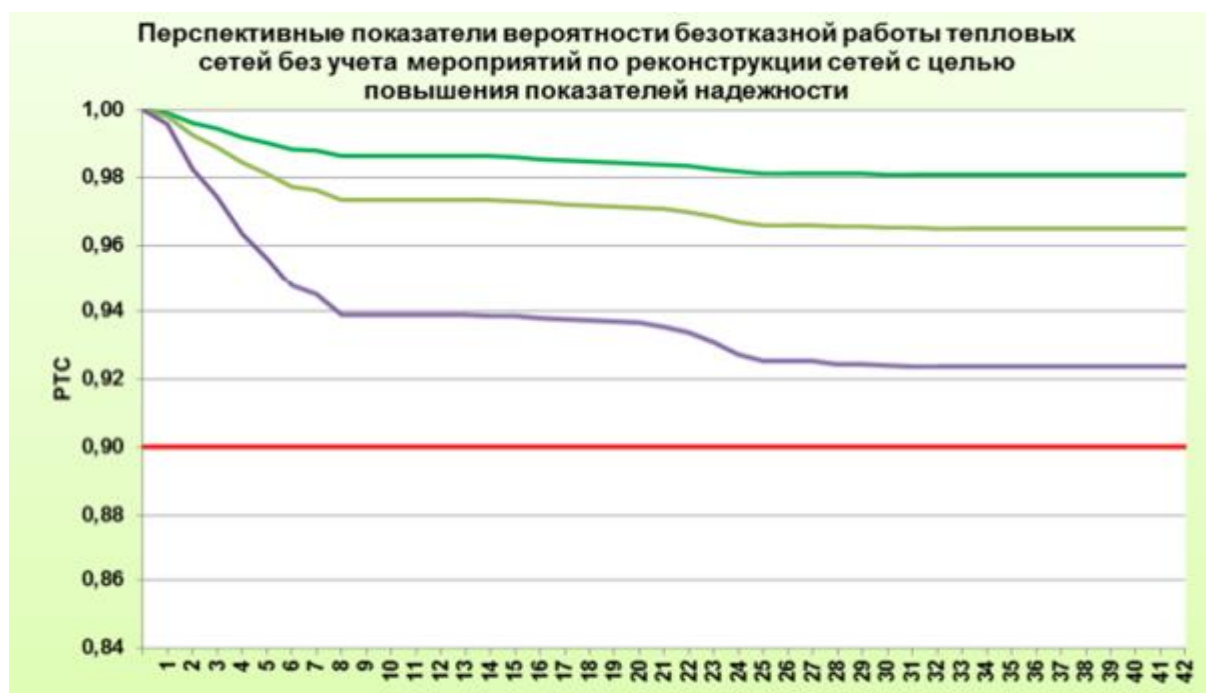
Рисунок 1.3 Вероятность безотказной работы тепловых сетей от ТК-45 до С-28п-16
