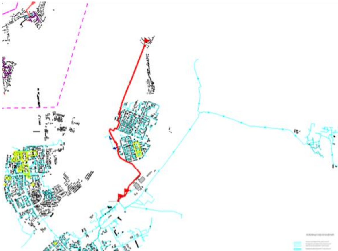
Рисунок 1.9 Путь для расчёта вероятности безотказной работы тепловых сетей от Архангельской ТЭЦ до потребителя ИП Зеленин
